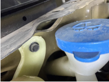
لغد الجناح الامامي اليمين lighad Right front wing متضرر damaged
