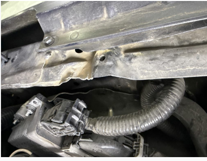
لغد الجناح الامامي اليمين lighad Right front wing متضرر damaged
